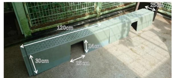
2つのトンネルを接続して中央部に開口部を設置
